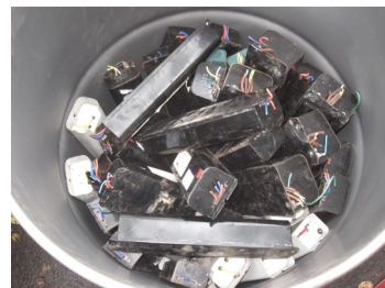
保管されている安定器
